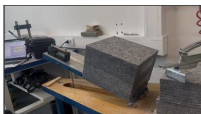
Figur 9 Glidning på skråplan. Oppsett for måling av hvilefriksjon (Tilttest). Apparatet tiltes helt til øvre stein begynner å gli. Bilde/skisse: SINTEF
